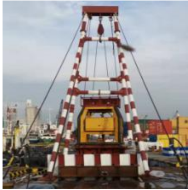
图 3 Roson 海床式孔压静力触探设备图 Fig. 3 Roson seabed CPTU system
